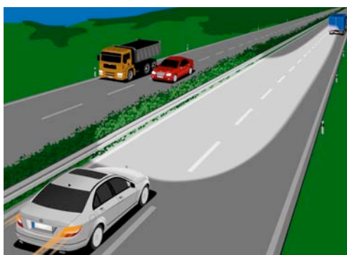
Luce autostradale: Distribuzione della luce più regolare e profonda rispetto ai tradizionali anabbaglianti (immagine piccola in alto).
