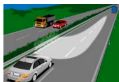
Luce autostradale: Distribuzione della luce più regolare e profonda rispetto ai tradizionali anabbaglianti (immagine piccola in alto).
